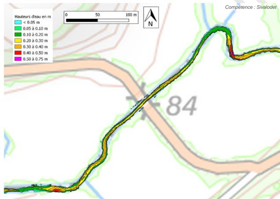
Extrait du modèle 2D à l'étiage sur le site de Park Jaffré à l'état actuel (hauteurs d'eau).
