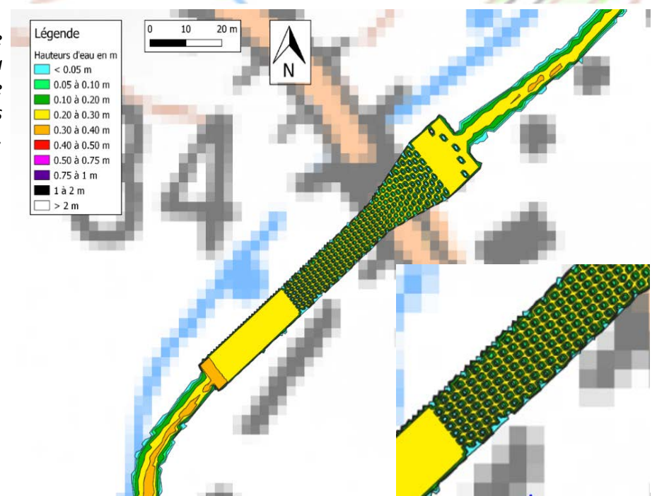
Extrait du modèle 2D à l'étiage sur le site de Park Jaffré à l'état projet avec zoom sur le pertuis et ses rugosités (hauteurs d'eau).
