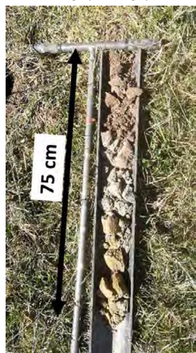
Tarière utilisée pour les sondage pédologique
